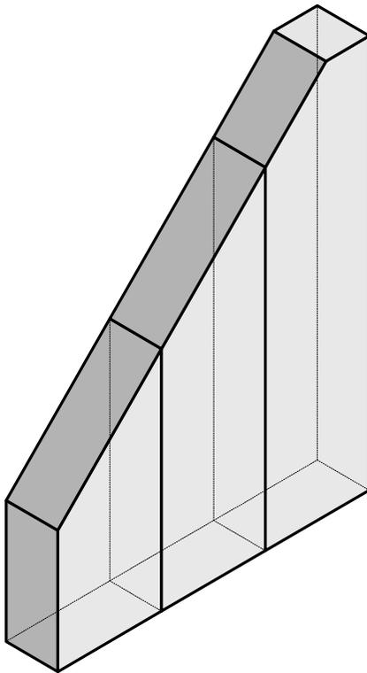
**Giebelelemente werden unter Berücksichtigung der konkreten Dachkonstruktion bemessen und werksseitig exakt geschnitten**
